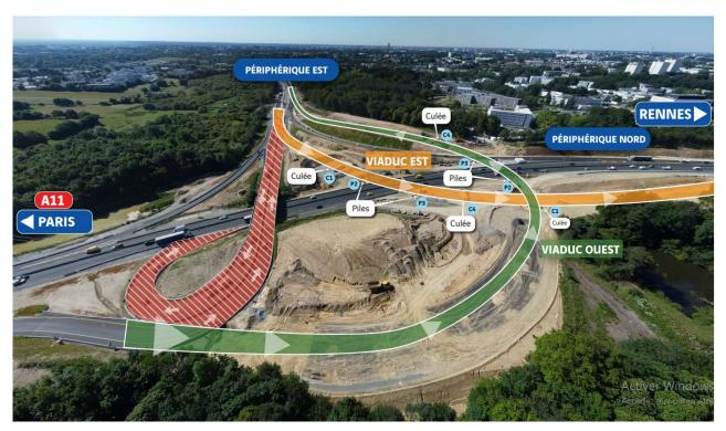
Les appuis de l'ouvrage ayant déjà été construits (photo ci-contre : deux piles et deux culées en extrémités), c'est au tour de la charpente métallique d'être mise en place. Après l'assemblage et le soudage sur place, aux abords de l'autoroute, des 18 premiers éléments de la charpente métallique, le premier lançage du viaduc ouest s'est déroulé ce jeudi 3 novembre 2022.
